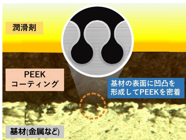
基材への施工イメージ
