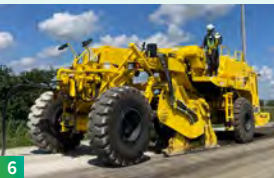
ICT を活用した ロードスタビライザによる 「スタビセメント RC 工法」
