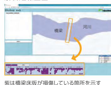
紫は橋梁床版が損傷している箇所を示す
