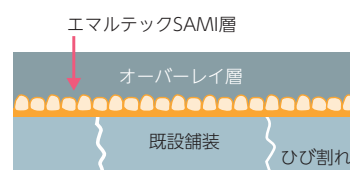
施工断面の例
