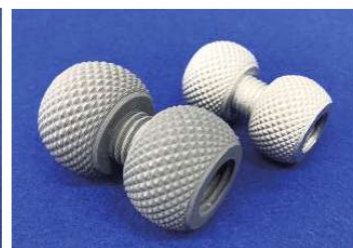
ボルト・ナット(左:造形品 右:焼結品)
