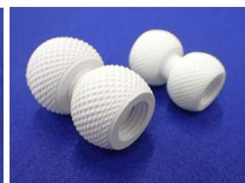
ボルト・ナット(左:造形品 右:焼結品)
