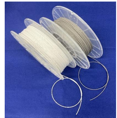
3D プリント用フィラメント (左：アルミナ 右：SUS316L)
