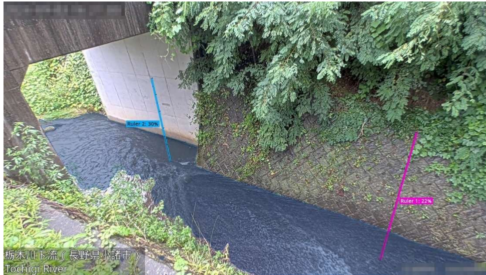
Noema AI 洪水検知アプリケーションによる水位検知の様子（長野県小諸市・栃木川）
