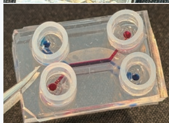
実際に検証に用いている 生体模倣チップ
