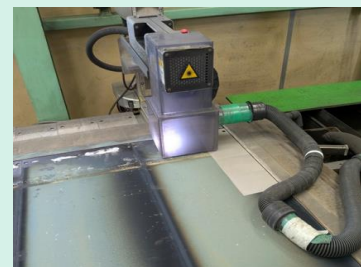
▲ レーザー剥離装置
