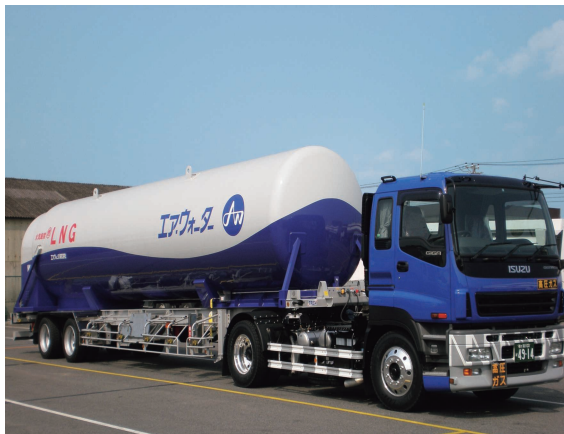
LNGローリー
