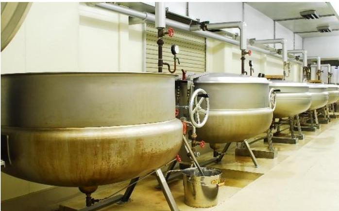
焼豚を炊く蒸気釜、1回に約1トンの焼豚を製造しています。
