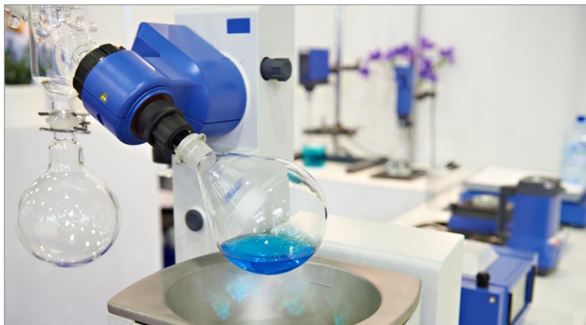
エバポレーターによる試薬濃縮
