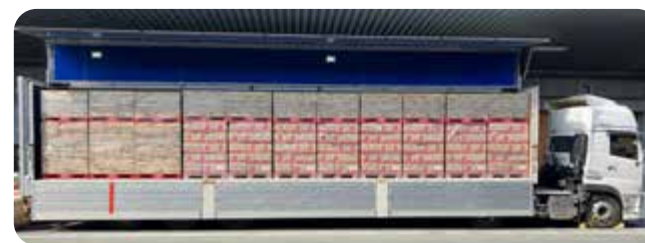
下段に（株）伊藤園様の飲料（重量物）、 上段に森永製菓の菓子（軽量物）を混載
