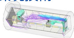
ISSにおける気流とCO2濃度のCFDシミュレーション例
