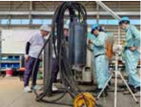
パイプレータトレミ性能試験
