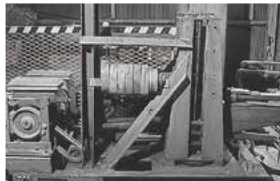
重錘型緊張機（技術研究所に保管） 造船所時代に培われた技術力と「創意工夫力」を活かし、量産化に欠かせない様々な製造機械を開発
