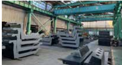
橋桁用鋼製型枠製作状況
