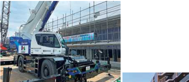
バッテリー式フル電動ラフテレーンクレーンの採用
