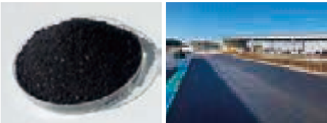
アスファルトと混合するバイオ炭（左） バイオ炭アスコン施工事例 [日本道路土浦テクノBASE（茨城県土浦市）]（右）
