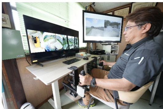
レバーとペダルを使った遠隔操作で無人重機を操作（写真は松崎重機の事務所 ㊟ と駒ヶ根市内の現場）
