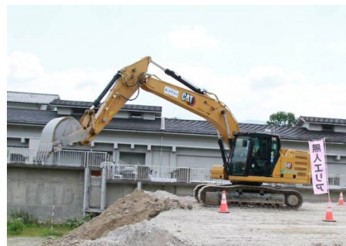
レバーとペダルを使った遠隔操作で無人重機を操作（写真は松崎重機の事務所 ㊟ と駒ヶ根市内の現場）
