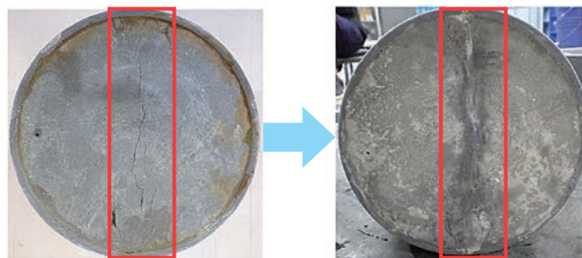
実験開始時 (漏水量 96ml、ひび割れ幅 0.33mm)
