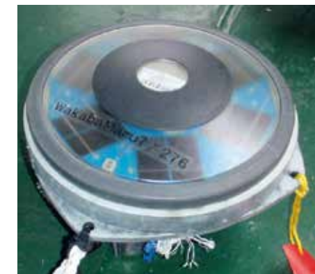
海洋ごみ流出防止のためFADsおよび魚探ブイに取り付けるソナー衛星ブイ
